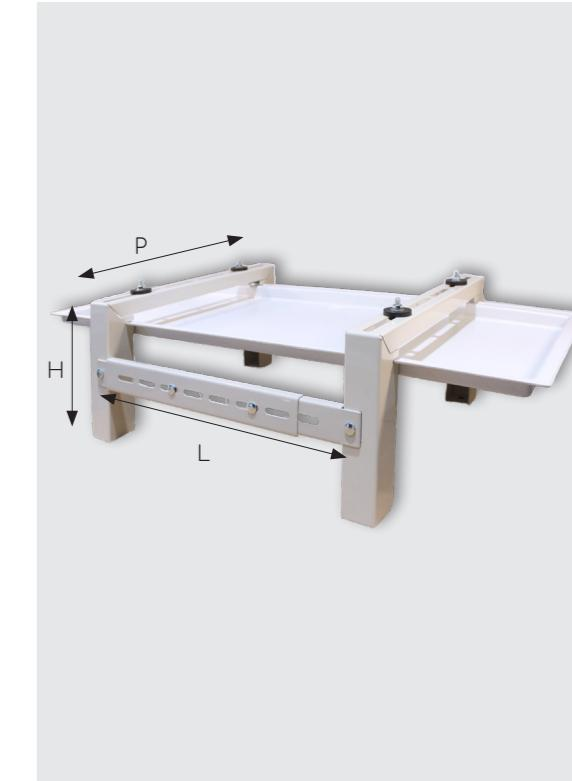
Staffa a pavimento realizzata in lamiera elettrozincata e verniciata con polveri epossidiche (RAL 9002). Lunghezza regolabile da un minimo di 450mm ad un massimo di 790 mm. Progettata per essere fissata ai nostri supporti a pavimento Sumo. Composta di bacinella raccogli condensa e barre regolabili che consentono una maggiore compattezza e stabilità. Completa di viteria di fissaggio e gommini antivibranti.
