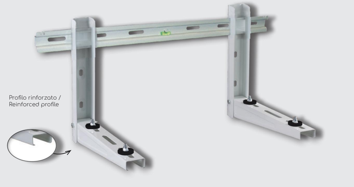
Staffe regolabili universali realizzate in lamiera eletrozincata e verniciata con polveri epossidiche (RAL 9002). Installazione e calcolo dell'interasse facilitato. Complete di livello, viteria di fissaggio, tasselli, gommini antivibranti e dell'innovativo piedino posteriore regolabile composto da un corpo filettato in nylon caricato fibra NBR per una perfetta aderenza alla parete. Elevato assorbimento delle vibrazioni prodotte.
