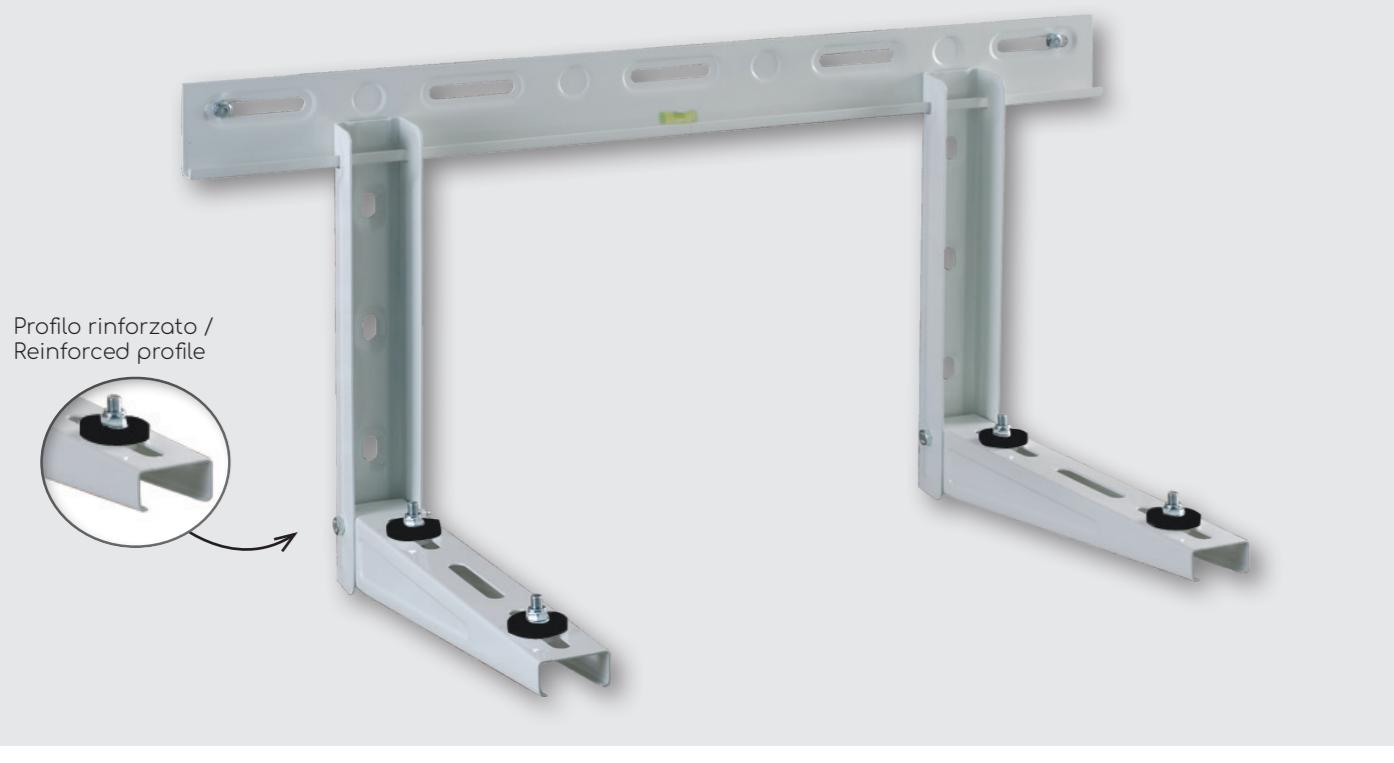
Staffe regolabili universali realizzate in lamiera eletrozincata e verniciata con polveri epossidiche (RAL 9002). Installazione e calcolo dell'interasse facilitato. Complete di livella, viteria di fissaggio, tasselli, gommini antivibranti e dell'innovativo piedino posteriore regolabile composto da un corpo filettato in nylon caricato fibra NBR per una perfetta aderenza alla parete. Elevato assorbimento delle vibrazioni prodotte.
