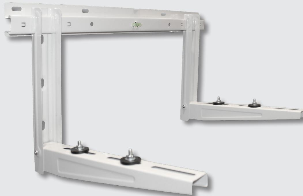
Staffe regolabili universali realizzate in lamiera elettrozincata e verniciata con polveri epossidiche (RAL 9002). Installazione e calcolo dell'interasse facilitato. Complete di livella, viteria di fissaggio, tasselli, gommini antivibranti e dell'innovativo piedino posteriore regolabile composto da un corpo filettato in nylon caricato fibra NBR per una perfetta aderenza alla parete. Elevato assorbimento delle vibrazioni prodotte.
